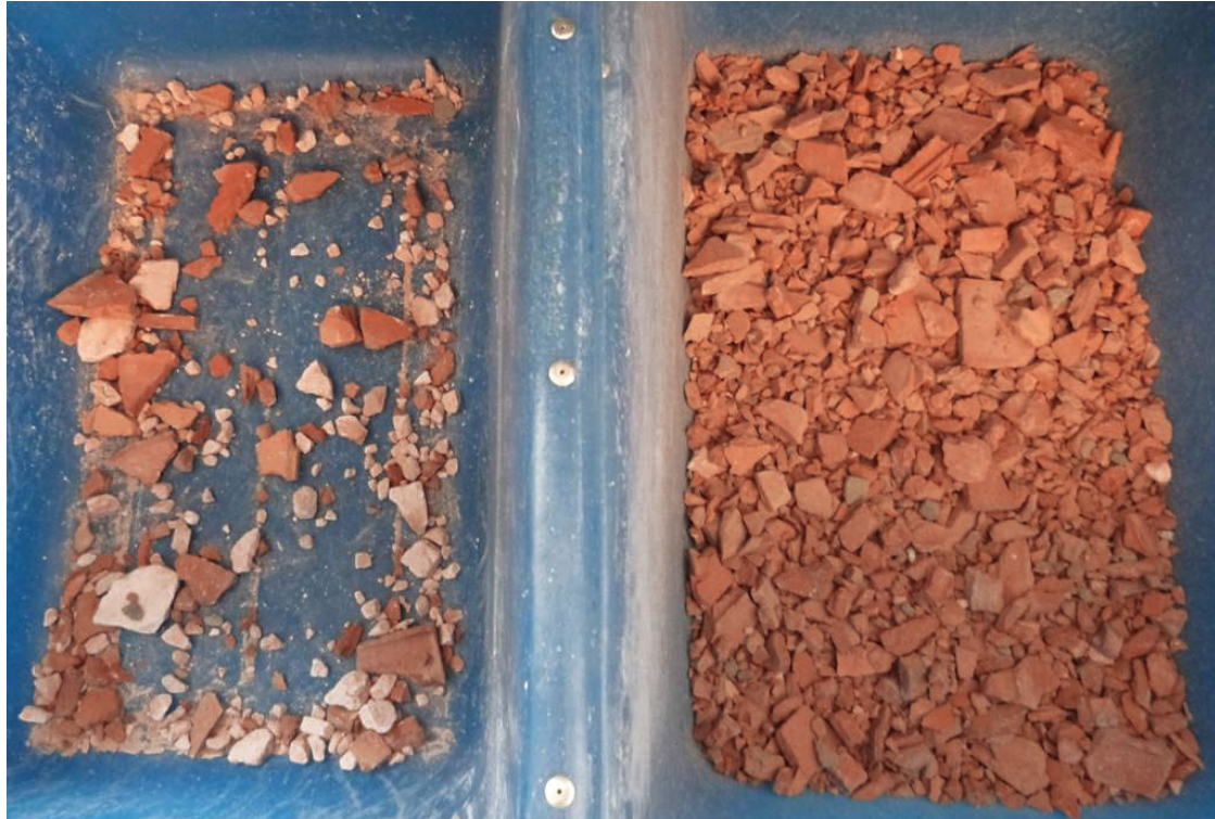
Bild 1: Ergebnis der Aussortierung von Gipsputzen
